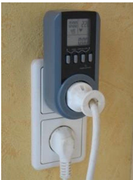
Ilustracija 72 – Primjer mjernog uređaja za električnu energiju za identifikaciju neučinkovitih uređaja 81
